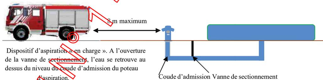
Un dispositif est dit « à réseau sec » lorsque le niveau haut de l'eau est toujours situé en dessous du coude d'admission du dispositif hydraulique qui l'équipe. A l'arrêt de l'aspiration l'eau retombe naturellement dans le bassin. Les colonnes d'aspiration et les Poteaux d'Aspiration à Réseau Sec (P.A.R.S) sont adaptés pour ce type d'aménagement.
