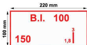
Cette plaque indique qu'une bouche incendie de 100 mm (BI DN 100), raccordée sur une canalisation de 150 mm, est implantée à 3 m devant la plaque et à 1,8 m sur la gauche.
