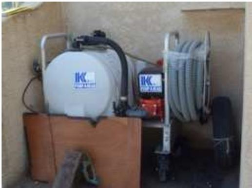
Une pompe mobile sur roues - **eaux noires, eaux grises**- munies d'un réservoir de 80 l en PVC permet l'aspiration directement à l'emplacement du bateau demandeur. Ce matériel est à la disposition de l'utilisateur sous contrôle du Maître de Port.
